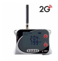
L' enregistreur de données GSM est conçu pour enregistrer la température et l' humidité et CO2. En cas de dépassement des limites définies, les messages SMS et JSON peuvent être envoyés via une connexion de données GPRS. Il est possible de définir l' envoi régulier de messages JSON à la base de données COMET, l' intervalle d' envoi est réglable.
