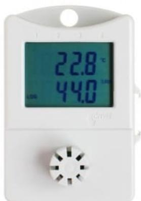
L'enregistreur de données est conçu pour enregistrer la température et l'humidité. Les valeurs sont stockées dans une mémoire électronique non volatile. Le transfert de données vers l'ordinateur personnel pour une analyse ultérieure est effectué via une interface USB, RS232, GSM ou Ethernet à l'aide d'un adaptateur de communication approprié.
