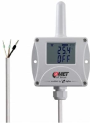
L'instrument mesure la température à partir du capteur interne intégré et dispose de deux entrées binaires pour surveiller les variations de tension ou pour surveiller l'état de contact sans tension. Il présente une conception simple et compacte et est positionné directement dans la zone mesurée. Les valeurs mesurées sont affichées à l'écran et sont envoyées régulièrement, dans un intervalle de temps ajustable (10 min à 24 h), par transmission radio de Sigfox à COMET Cloud.
