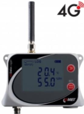
L'enregistreur de données est conçu pour enregistrer la température et l'humidité de la sonde externe. En cas de dépassement des limites définies, les messages SMS et JSON peuvent être envoyés via une connexion de données 4G. Il est possible de définir l'envoi régulier de messages JSON à la base de données COMET, l'intervalle d'envoi est réglable. L'enregistrement est effectué dans une mémoire électronique non volatile. Les données peuvent être transférées sur un PC via USB-C.
