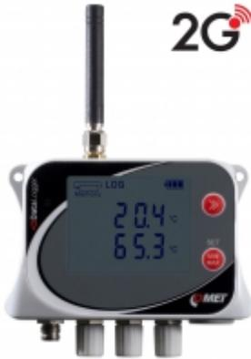
L'appareil est conçu pour enregistrer la température de quatre sondes Pt1000 externes. En cas de dépassement des limites définies, les messages SMS et JSON peuvent être envoyés via une connexion de données GPRS. Il est possible de définir l'envoi régulier de messages JSON à la base de données COMET, l'intervalle d'envoi est réglable. L'enregistrement est effectué dans une mémoire électronique non volatile. Les données peuvent être transférées sur un PC via USB-C.
