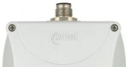
Version du transmetteur avec connecteur mâle étanche IP67 Lumberg RSFM4 au lieu du presse-étoupe pour faciliter la connexion / déconnexion de la sortie. Spécifiez s&apos;il vous plaît votre commande avec la lettre L derrière le code du modèle (par exemple, TxxxxL).
