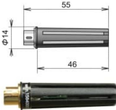
Sonde d'air précise et rapide -30 à + 80 ° C pour une insertion directe dans le connecteur de l'enregistreur. Tolérance  $t = \pm (0,10 + 0,0017 * |t|)$  selon EN 60751. Temps de réponse:  $t_{63} < 10s$ ,  $t_{95} < 30s$  (débit d'air 1m / s).
