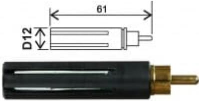
Sonde de température avec capteur Pt1000. Sonde d'air rapide et précise -30 à + 80 ° C pour une insertion directe dans le connecteur du Commeter D0211, D0221, D0241. Tolérance  $t = \pm (0,10 + 0,0017 * |t|)$  selon EN 60751. Temps de réponse:  $t_{63}$
